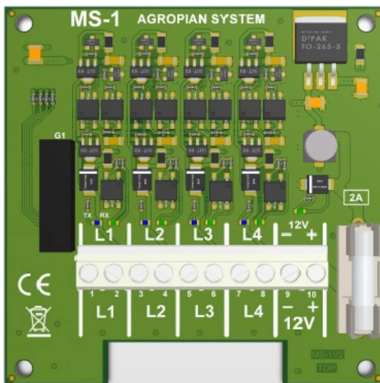
Rys. 1: Schemat rozmieszczenia zacisków na dolnej płytce sterownika MS-1.
